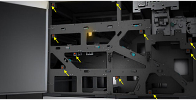
Diody sygnalizacyjne Światła LED kierują operatora do obszarów maszyny, które wymagają uwagi.
